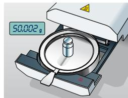
**Ajuste:** Ajuste do instrumento de medição até que a medição esteja correta: Primeiro, o desvio é detectado entre o valor medido e o valor verdadeiro (calibração), então a correção correspondente é realizada.
