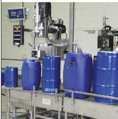
Quando o seu produto é caro, você não deve desperdiçá-lo através do excesso de enchimento do contêiner de alimentos a granel. Células de carga, módulos de pesagem e as balanças da METTLER TOLEDO podem ser facilmente integrados em sua máquina de enchimento para ter precisão em ambientes seguros e perigosos, garantindo-lhe proporções altas de precisão em enchimento para obter economias de custos.
