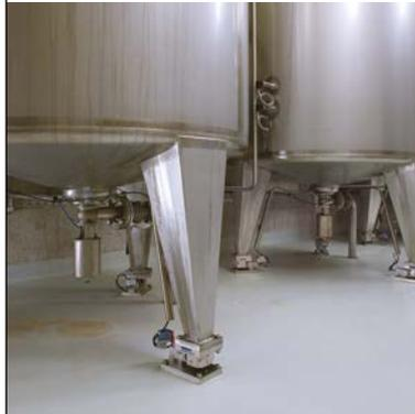
**A pesagem mantém um estoque preciso em tanques, silos ou funis.**
