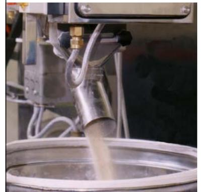
Materiais secos são melhores processados por pesagem, porque o peso é uma medida mais constante do que o volume. Se você está tendo variações em seus resultados de pesagem, considere o uso dos sensores de automação e células de carga da METTLER TOLEDO em seus sistemas por adição e perda de peso.
