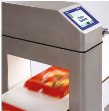
Se a presença de corpos estranhos em seu produto for significativa a ponto de prejudicar os clientes ou a realização dos processos, considere um detector de metais ou sistema de inspeção por raios X integrado para rejeitar automaticamente produtos que não estiverem conforme o padrão estabelecido. Assim, tanto os consumidores quanto a produção a jusante e os equipamentos de embalagem ficam protegidos contra danos.
