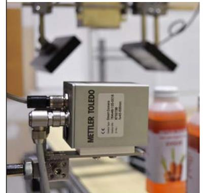
Ao serem integrados a seu sistema de automação, os sistemas de inspeção visual da METTLER TOLEDO validarão e coletarão dados como a presença precisa da etiqueta, posição da etiqueta, enviesamento da etiqueta, ID da etiqueta, registros da etiqueta e texto legível.
